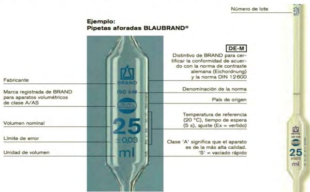
Imagen 4.- En la imagen se observan algunos de los datos que pueden estar grabados en los instrumentos volumétricos,
