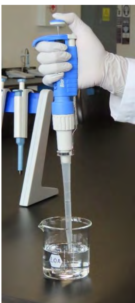
Imagen 9. Uso de la pipeta automática. Se carga y se descarga mediante la acción del dedo pulgar sobre un pistón que actúa sobre un cojín de aire que permite la succión del líquido con la punta de plástico que se coloca en el extremo opuesto al pistón
