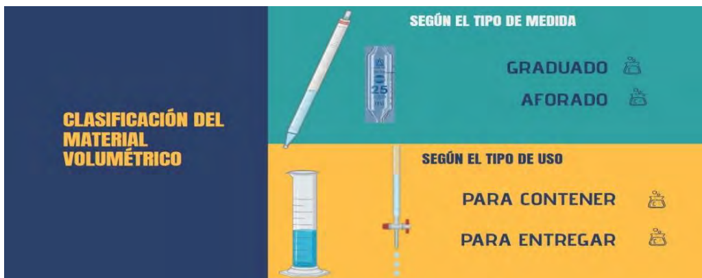
Imagen 1. Clasificación del material volumétrico empleado en el laboratorio según el tipo de medida y uso.
