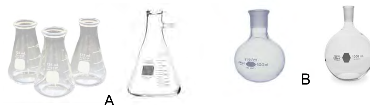
Imagen 7.- Diferentes tipos de matraces según su diseño y propósito. A) Matraces Kitazato, B) matraces bola
