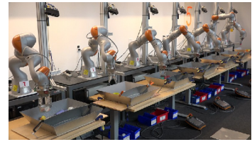
Banco de entrenamiento del sistema QT-Opt, con siete robots que trabajan en paralelo para acelerar el aprendizaje.
